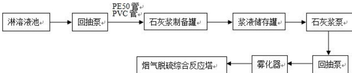
图 4-1 淋溶液回用流程图
